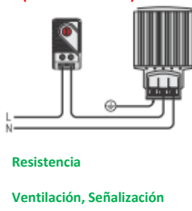
TPC15 Resistencia (Contacto abridor)
