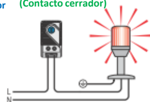
TPC15 p. ej. Indicador (Contacto cerrador) de señal
